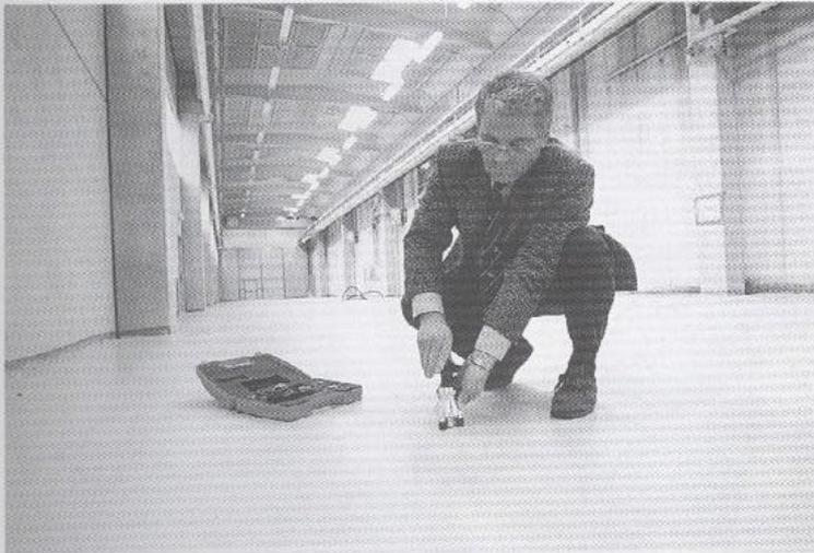
**Fig. 6 - Prova di pull-off**
